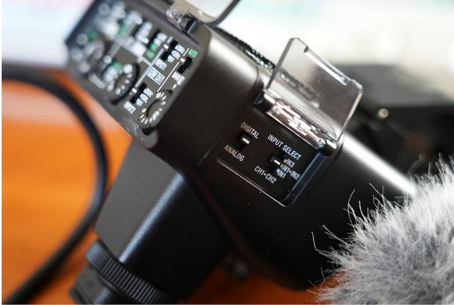
*Réglage pour un récepteur Wisycom MPR51 ou MPR52 double pour l'entrée sur mini-jack 3,5.*
